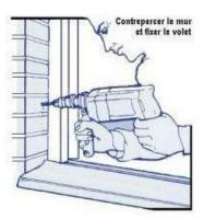
La serrure se trouve soit sur la lame finale (lame du bas), soit sur une lame intermédiaire. Il faut percer le fond des glissières à hauteur des tiges de serrure :
