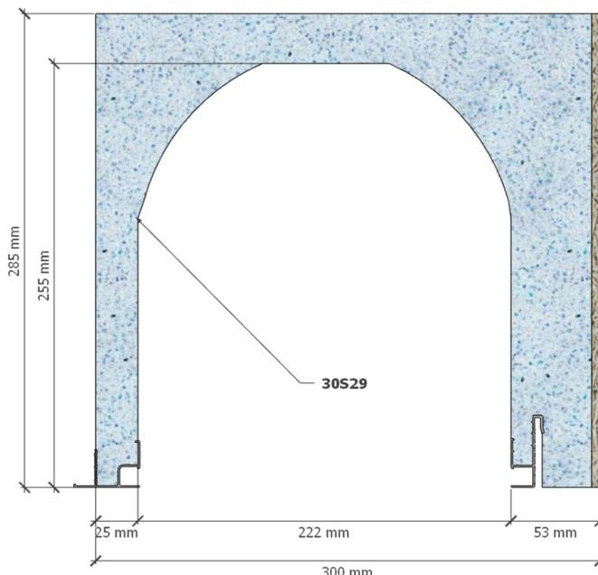
**Option cornière [PDF]** : les rails 8E permettent l'ajout du cornière d'étanchéité et de fixation avec la menuiserie. Ces cornières crantées de 40x30 mm sont livrables en paquet de 100 pièces ou insérées dans le coffre.
