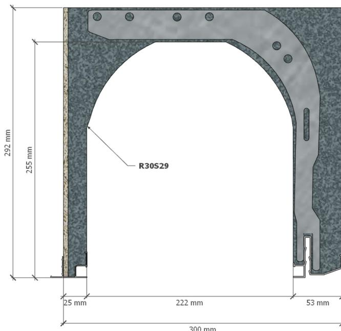
**Option équerres et ligatures [PDF]** : conformément à l'avis technique du CSTB, les coffres renforcés seront ligaturés au chaînage et fixés à la traverse haute au mouen d'équerres. Équerres et ligatures sont livrables en paquet de 500 pièces ou intégrées dans le coffre à la production.
