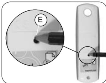
de crayon jusqu'au bref mouvement du volet roulant / store (ou une série de 3 « Bip ») : la fonction PROG est activée pendant environ 2 min.
